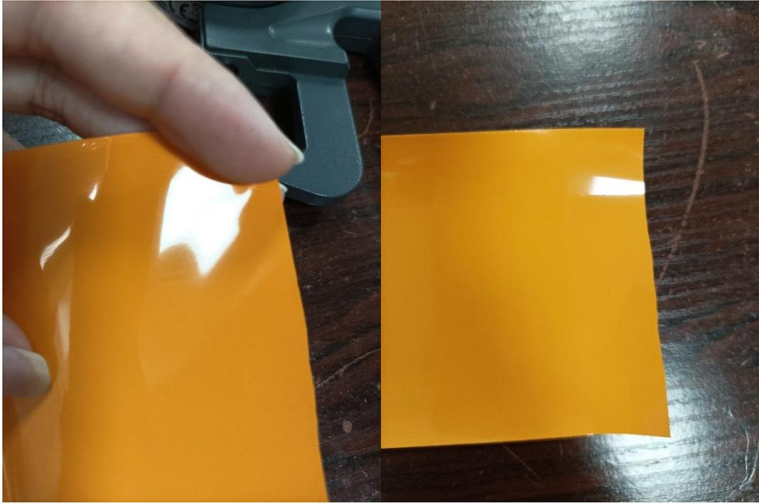
药液经制膜机成型干燥，薄干膜具备一定硬度，测厚规夹持力不会导致口腔崩解膜厚度变形，测量后口腔崩解膜表面无测量头印痕。
