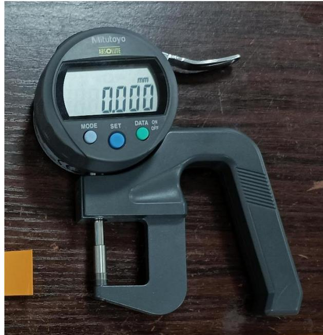
测厚规通过弹簧结构在测量头施加夹持力，力度平稳。
